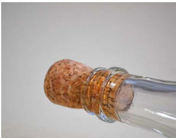
Una lavorazione difettosa del corpo in agglomerato può comportare l'applicazione di forze errate sul collo della bottiglia da parte del tappo.
